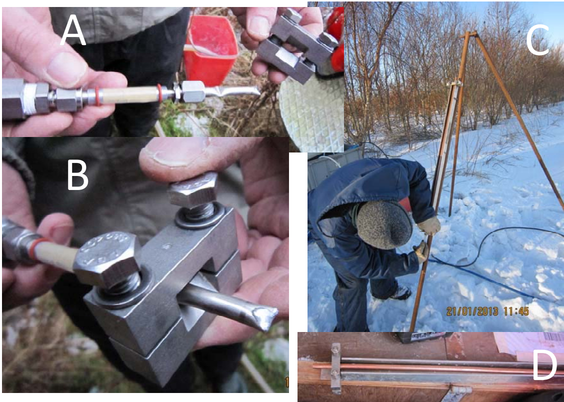
Figur 2 Prøvetagningsudstyr for helium-3 analyse af grundvand. Diffusionsamplere A-B, kobberrør C-D.
